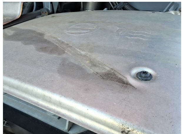
Beschädigung 3: Abgasanlage: Hitzeblech - verformt - erneuern
