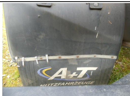
Kotflügel HL gebrochen
