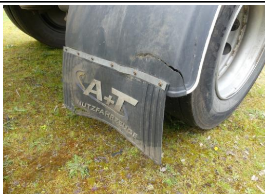
Kotflügel HR gebrochen
