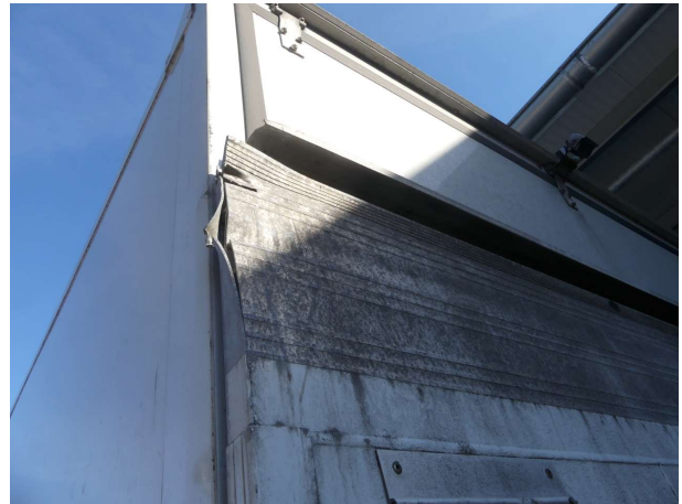
Beschädigung 9: Ladebordwand: Blatt - gebrochen / gerissen - instandsetzen
