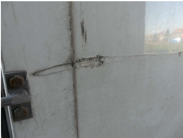
Beschädigung 10: Koffer: Seitenwand rechts - gebrochen / gerissen - instandsetzen und lackieren
