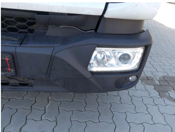
Beschädigung 12: Stossfänger vorn: Stossfänger vorn (unlackiert) - gebrochen / gerissen - erneuern
