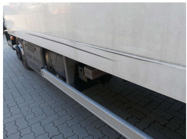
Beschädigung 8: Koffer: Seitenwand links - Kratzer - lackieren
