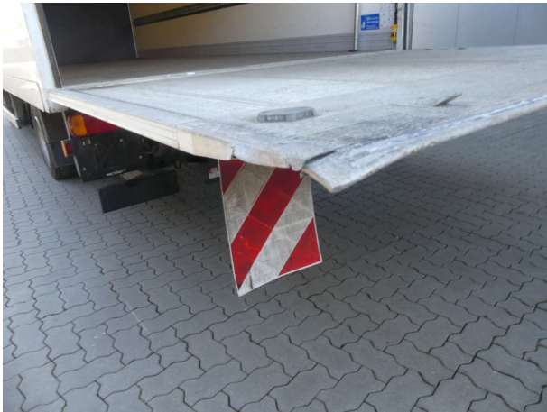
Beschädigung 9: Ladebordwand: Blatt - gebrochen / gerissen - instandsetzen
