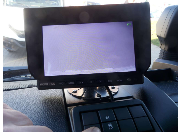
Beschädigung 2: elektronische Systeme: Rückfahrkamera (schlechtes Bild, Folgekosten möglich) - Funktion / Zulässigkeit
