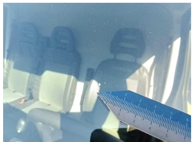
Beschädigung 5: Verglasung: Frontscheibe (im Fahrsichtfeld) - Steinschlag - erneuern
