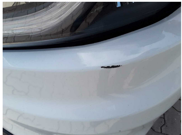
Beschädigung 7: Stossfänger vorn: Bugschürze links - Kratzer - lackieren
