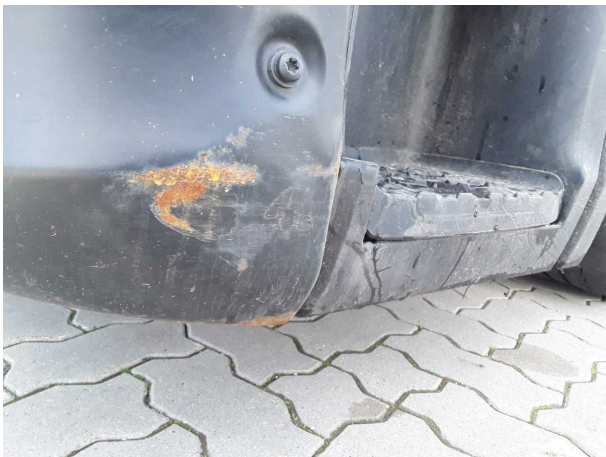
Beschädigung 5: Stossfänger vorn: Bugschürze links (unterhalb) - verkratzt / verschürft - lackieren
