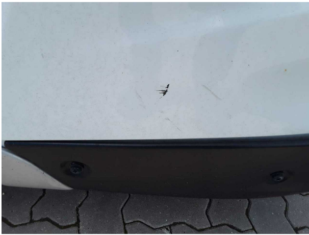
Beschädigung 7: Stossfänger vorn: Bugschürze links - Kratzer - lackieren
