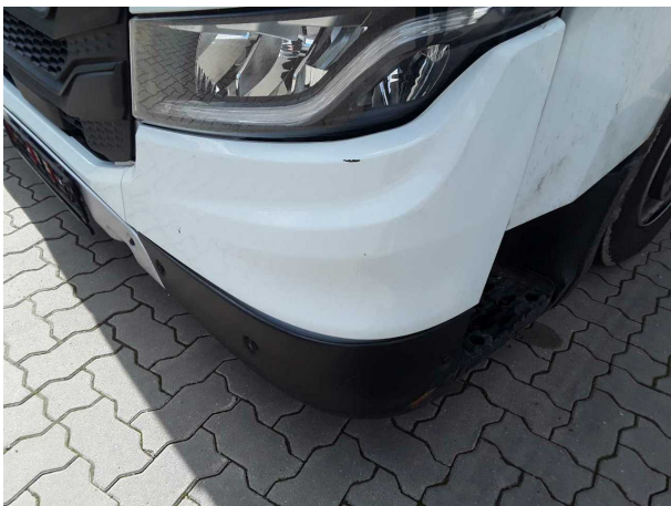
Beschädigung 7: Stossfänger vorn: Bugschürze links - Kratzer - lackieren
