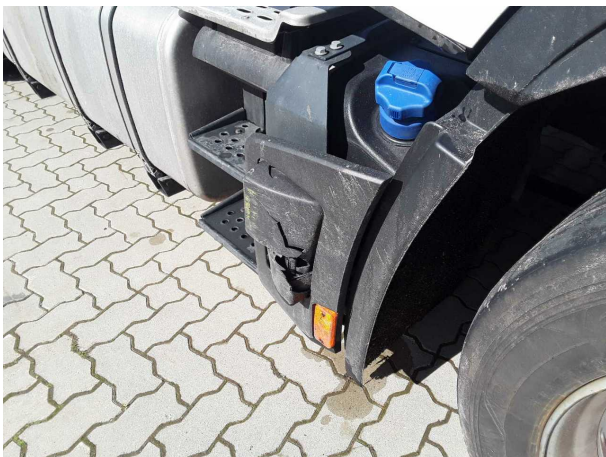
Beschädigung 12: elektronische Systeme: Abstandsregelsystem (Seitenradar) - gebrochen / gerissen -
