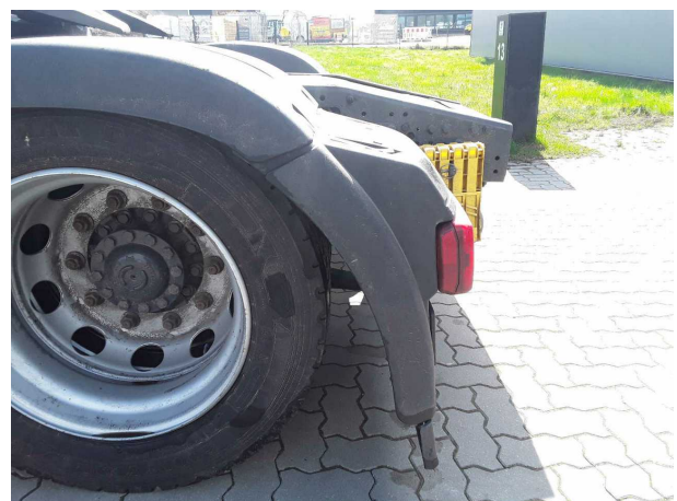
Beschädigung 2: Rahmen: Kotflügel hinten links hinten - Fehlstellung - instandsetzen
