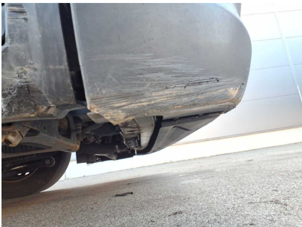
Beschädigung 12: Stossfänger vorn: Bugschürze rechts - gebrochen / gerissen - erneuern
