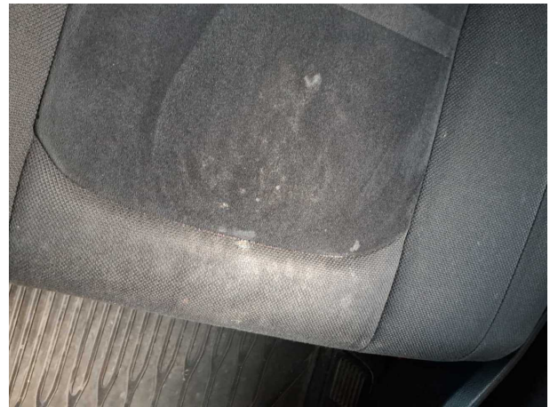
Beschädigung 2: Sitz vorn: Sitzbezug links - Brandloch - Smart Repair
