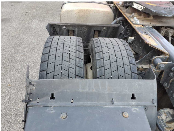
Beschädigung 14: Rahmen: Kotflügelabdeckung hinten links (und rechts) - fehlt - erneuern
