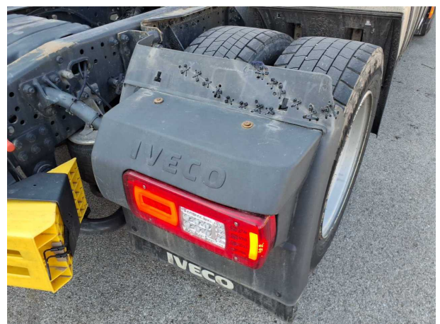
Beschädigung 16: Rahmen: Kotflügel hinten rechts hinten - gebrochen / gerissen - erneuern
