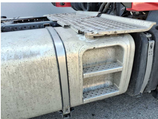
Beschädigung 19: Kraftstoffanlage: Tank rechts (instandgesetzt) - verformt - Wertminderung
