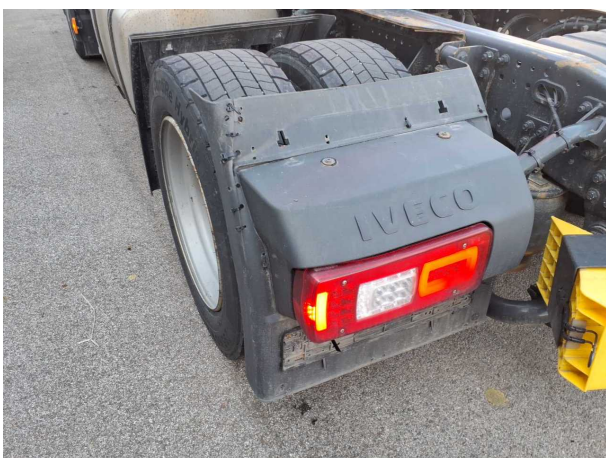
Beschädigung 15: Rahmen: Kotflügel hinten links hinten - gebrochen / gerissen - erneuern
