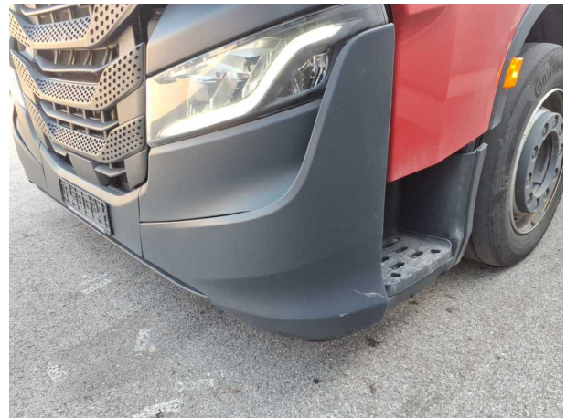
Beschädigung 11: Stossfänger vorn: Bugschürze links - gebrochen / gerissen - erneuern
