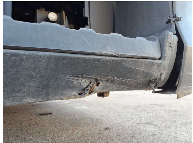
Beschädigung 7: Anbauteil rechts: Einstieg unten - gebrochen / gerissen - erneuern
