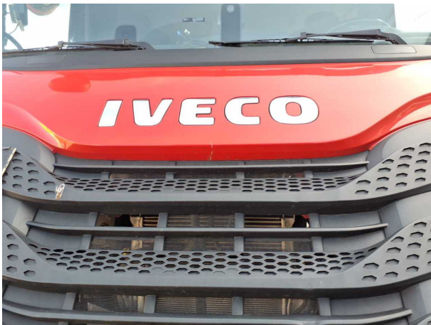
Beschädigung 18: Fahrerhaus: Frontklappe - gebrochen / gerissen - instandsetzen und lackieren
