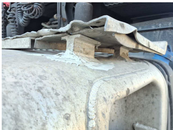
Beschädigung 19: Kraftstoffanlage: Tank rechts (instandgesetzt) - verformt - Wertminderung
