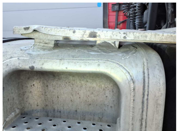
Beschädigung 19: Kraftstoffanlage: Tank rechts (instandgesetzt) - verformt - Wertminderung
