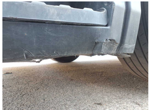
Beschädigung 6: Anbauteil links: Einstieg unten - gebrochen / gerissen - erneuern
