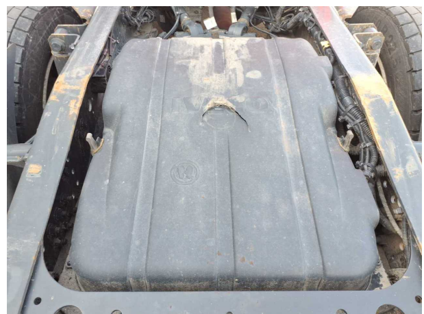
Beschädigung 1: elektrisches System: Batterieabdeckung - gebrochen / gerissen - erneuern
