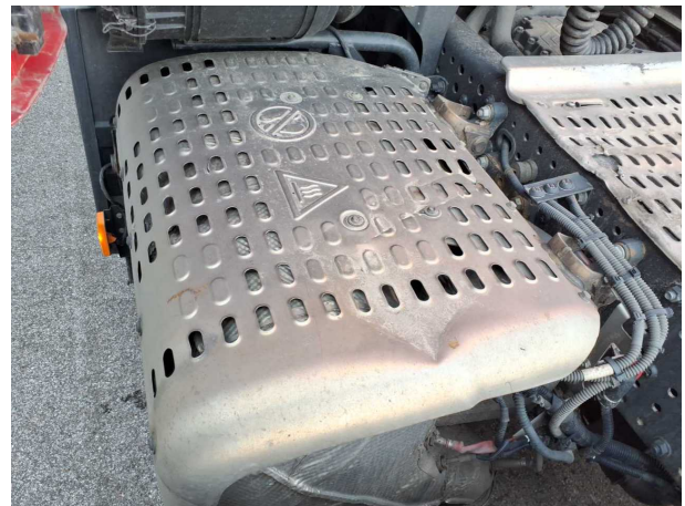
Beschädigung 5: Abgasanlage: Hitzeblech - verformt - erneuern
