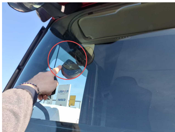
Beschädigung 21: Verglasung: Frontscheibe mit Spurhalteassistent (mit Rissbildung) - Steinschlag - erneuern
