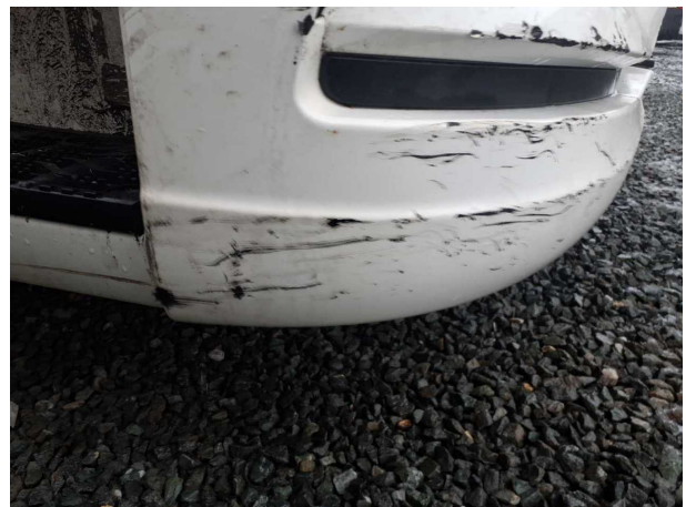
Beschädigung 13: Stossfänger vorn: Bugschürze rechts - verkratzt / verschürft - instandsetzen und lackieren
