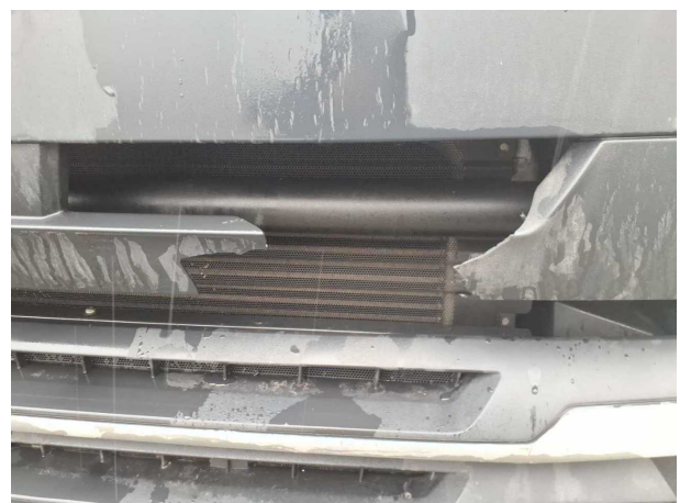
Beschädigung 2: Fahrerhaus: Frontklappe (Zierleiste unten) - gebrochen / gerissen - erneuern
