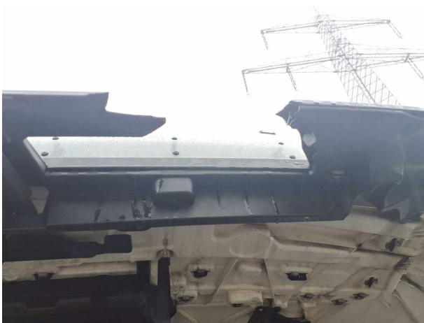
Beschädigung 2: Fahrerhaus: Frontklappe (Zierleiste unten) - gebrochen / gerissen - erneuern
