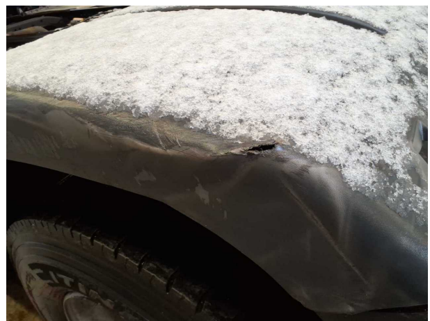
Beschädigung 3: Rahmen: Kotflügelabdeckung hinten links - gebrochen / gerissen - erneuern
