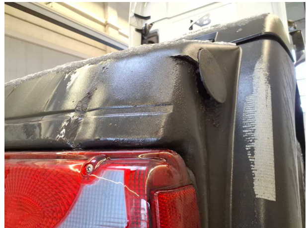
Beschädigung 9: Rahmen: Kotflügel hinten rechts hinten - gebrochen / gerissen - erneuern
