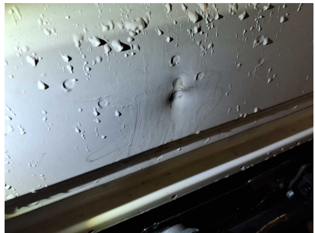
Beschädigung 7: Fahrerhaus: Rückwand - Delle / Lackschaden - Smart Repair
