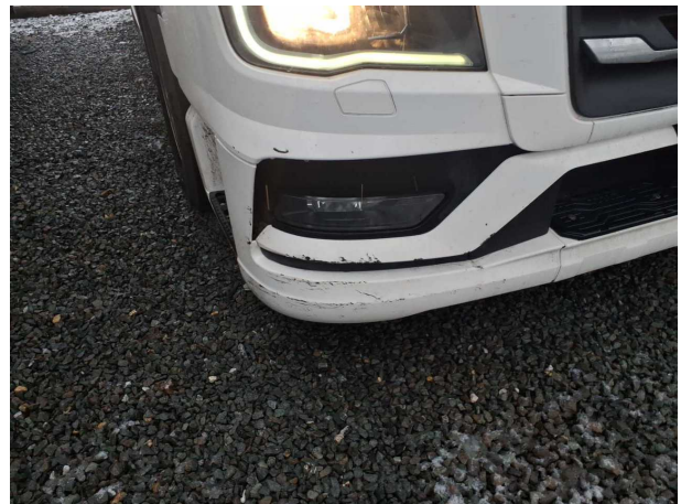
Beschädigung 5: Stossfänger vorn: Stossfänger vorn rechts - Lackmangel - Smart Repair
