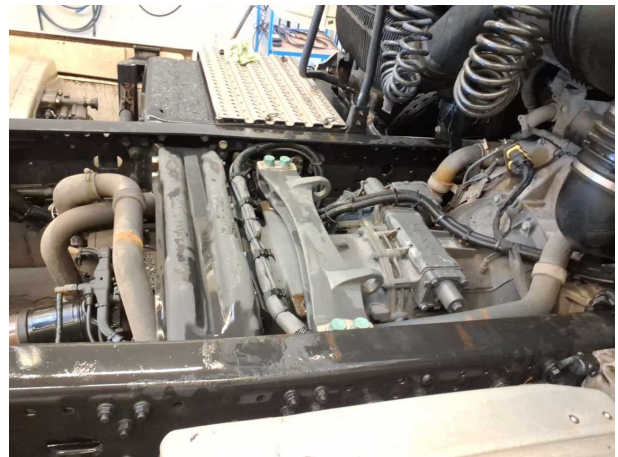
Beschädigung 12: Anbauteil links: Trittplatte oben (Mitte) - fehlt - erneuern
