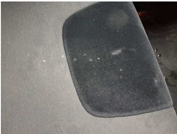
Beschädigung 4: Sitz vorn: Sitzbezug links - Brandloch - Smart Repair
