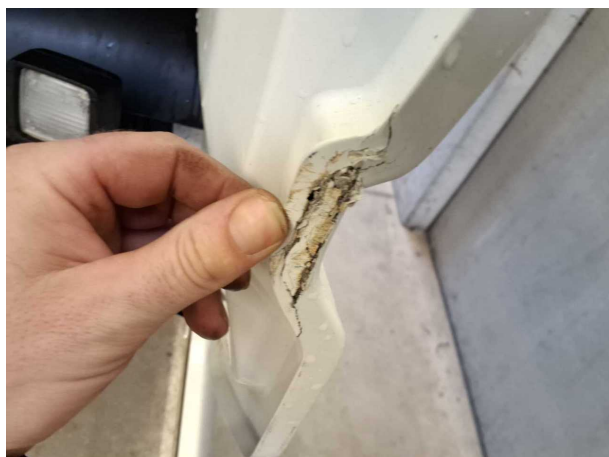
Beschädigung 14: Fahrerhaus: Luftleitkörper Dach rechts (unten) - gebrochen / gerissen - instandsetzen und lackieren
