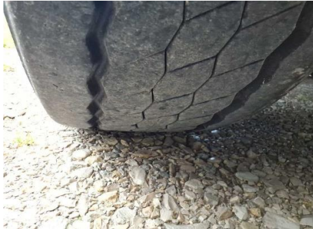
2 Reifen verschlissen / beschädigt
