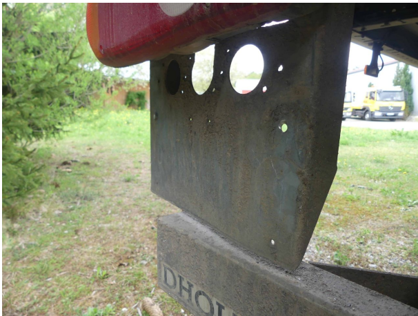
Beschädigung 2: Stossfänger hinten: Kennzeichenträger (links) - verformt - instandsetzen
