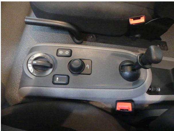
Beschädigung 3: elektrisches System: Kombischalter (Menüscharter Mittelkonsole klemmt/schwergängig) - Funktion /
