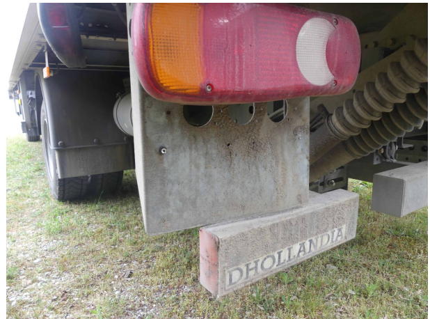
Beschädigung 2: Stossfänger hinten: Kennzeichenträger (links) - verformt - instandsetzen
