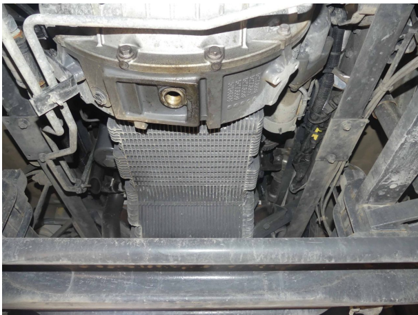
Beschädigung 7: Motor: Motor (Getriebe Ölfeucht, Folgekosten möglich) - Funktion / Zulässigkeit - Diagnose
