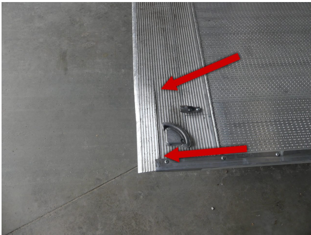
Beschädigung 6: Ladebordwand: Ladebordwand (Loch) - gebrochen / gerissen - instandsetzen
