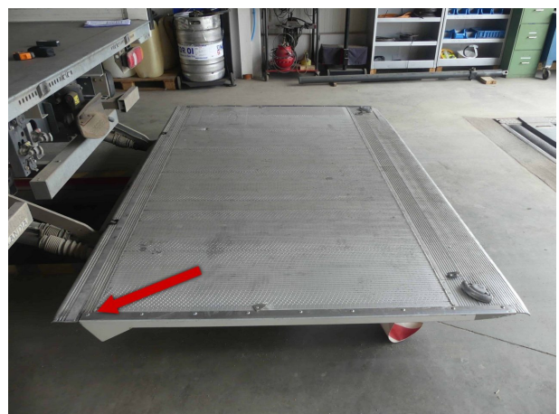
Beschädigung 6: Ladebordwand: Ladebordwand (Loch) - gebrochen / gerissen - instandsetzen
