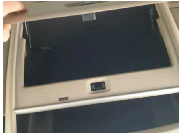
Beschädigung 4: Interieur: Staufachdeckel über WSS (Gasfedern) - defekt - erneuern
