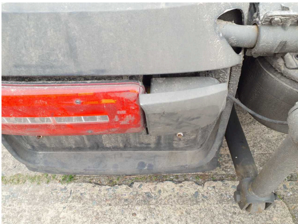
Beschädigung 5: Rahmen: Kotflügel hinten links hinten (Abdeckung) - lose - erneuern
