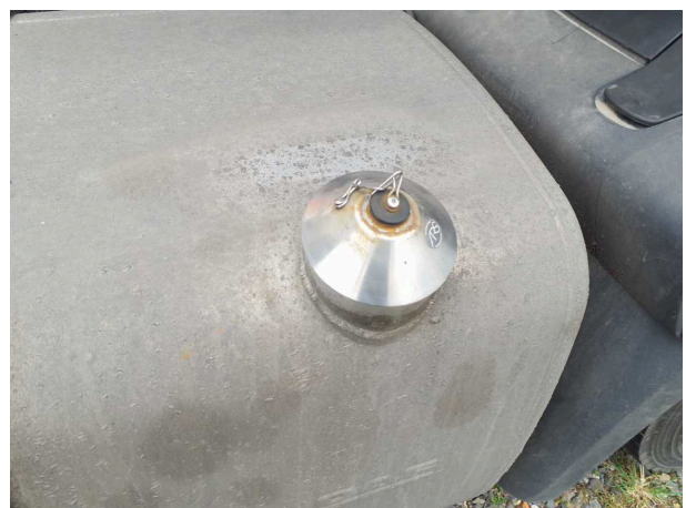
Beschädigung 9: Kraftstoffanlage: Tankdeckel abschließbar (links und rechts) - abweichend Auslieferungszustand -
