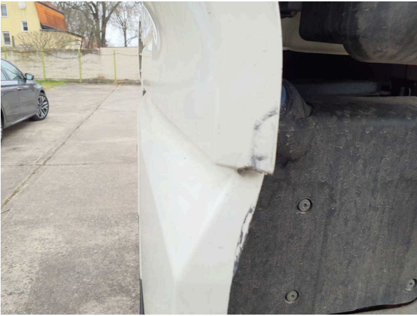
Beschädigung 16: Fahrerhaus: Luftleitkörper Dach links - gebrochen / gerissen - instandsetzen und lackieren
