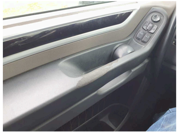
Beschädigung 10: Tür vorn links: Griff innen - verschlissen - erneuern
