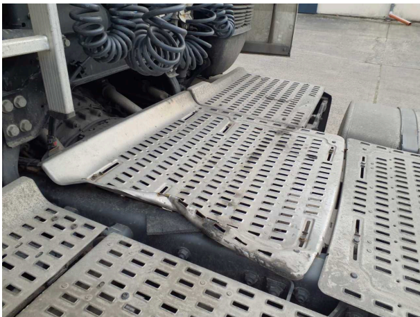
Beschädigung 13: Rahmen: Auftritt hinter Fahrerhaus Mitte - verformt - erneuern
