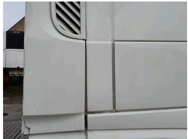
Beschädigung 15: Fahrerhaus: Seitenwand rechts - Delle / Lackschaden - instandsetzen und lackieren
