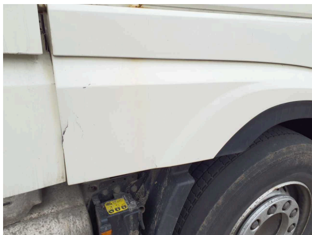
Beschädigung 18: Anbauteil rechts: Kotflügel vorn Hinterteil - gebrochen / gerissen - erneuern
