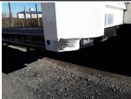
Stirnwand rechts unten Ecke verformt
