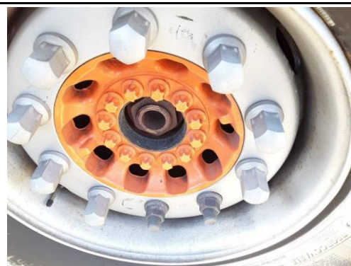
Nabenabdeckung links Mitte fehlt
