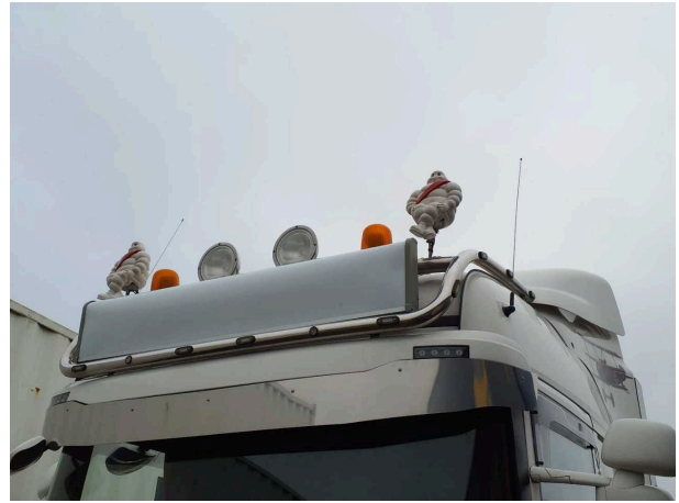
Beschädigung 5: elektrisches System: elektrische Ausrüstung (Lampen, Zulässigkeit prüfen, Folgekosten möglich) - Funktion /
