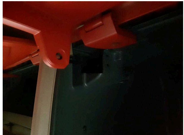
Beschädigung 1: Instrumententafel: Ablagefachdeckel (Dämpfer) - verschlissen - erneuern
