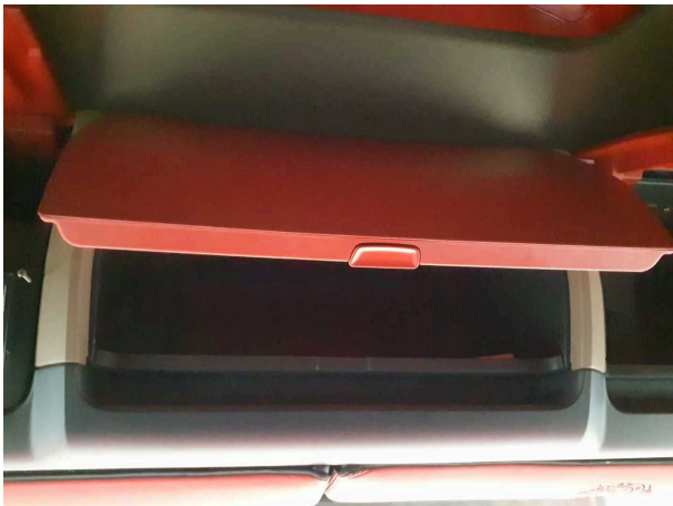
Beschädigung 1: Instrumententafel: Ablagefachdeckel (Dämpfer) - verschlissen - erneuern
