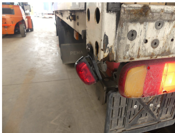
Beschädigung 1: Zusatzleuchte: Zusatzleuchte - lose - instandsetzen
