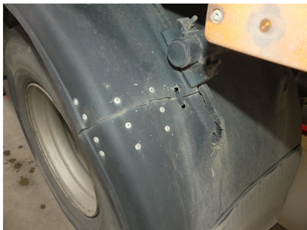
Beschädigung 10: Rahmen: Kotflügel hinten links - gebrochen / gerissen - erneuern
