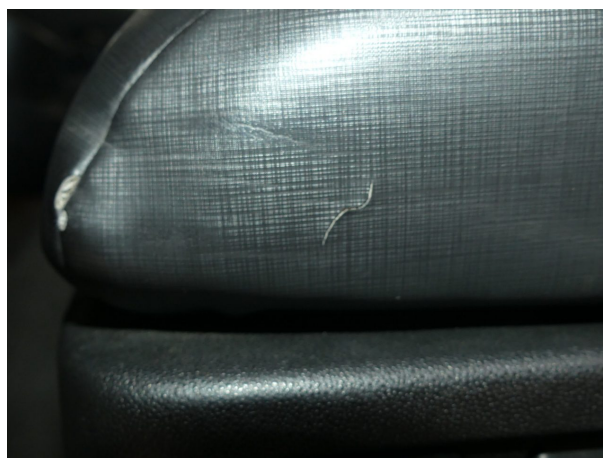
Beschädigung 5: Sitz vorn: Sitzbezug links (Risse in den Wangen) - instandsetzen
