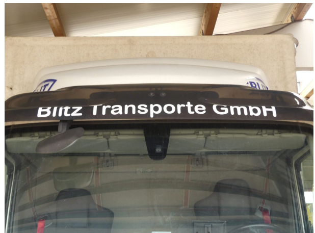
Beschädigung 7: Fahrerhaus: Fahrerhaus - beklebt/ beschriftet - entkleben/neutralisieren
