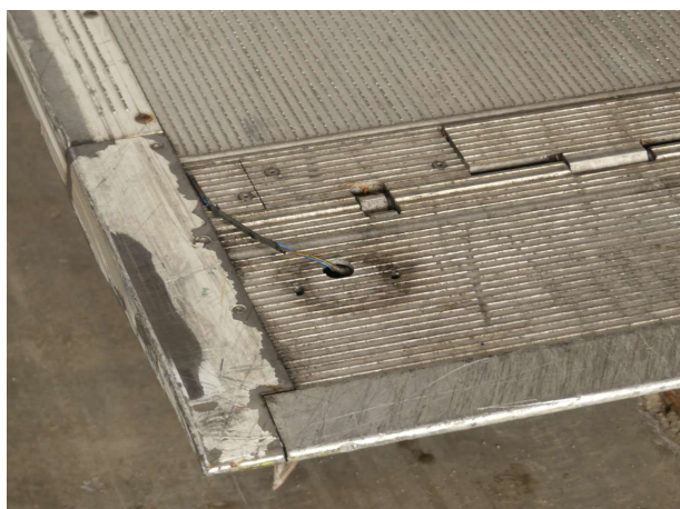
Beschädigung 4: Ladebordwand: Warnblinkleuchte - gebrochen / gerissen - erneuern
