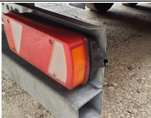
Begrenzungsleuchte hinten rechts gebrochen
