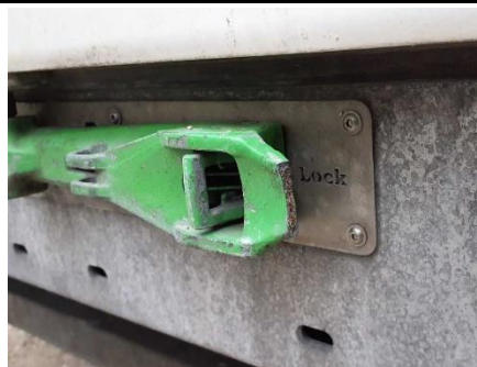
Türöffner hinten rechts gebrochen
