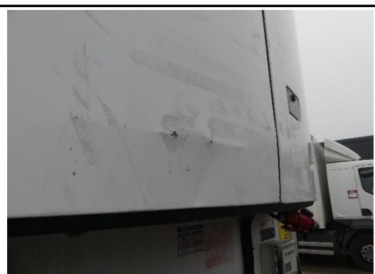
Wartungsklappe Kühlgerät verformt
