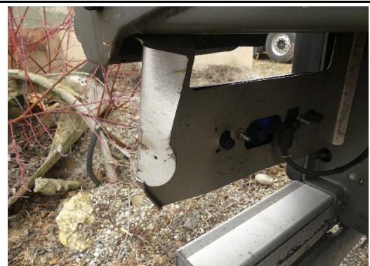
Schlusslichträger rechts verformt
