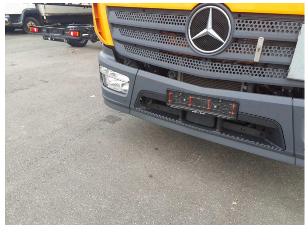
Beschädigung 10: Stossfänger vorn: Stossfänger vorn (Verstärkung) - gebrochen / gerissen - erneuern
