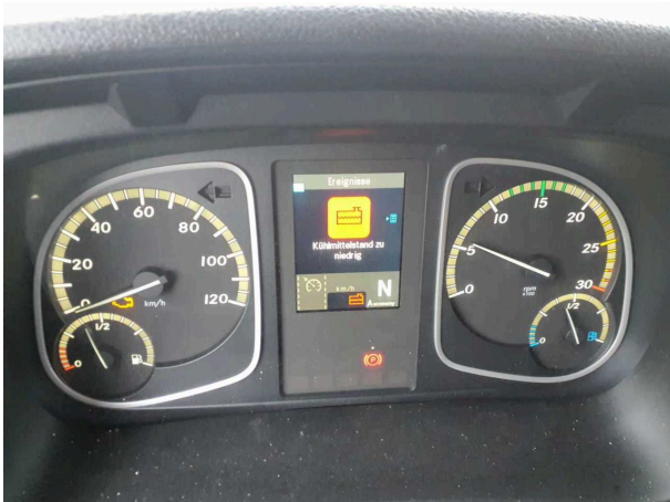
Beschädigung 6: Motorkühlung: Kühflüssigkeit (Zu niedrig (Folgekosten möglich)) - befunden ggf. instandsetzen
