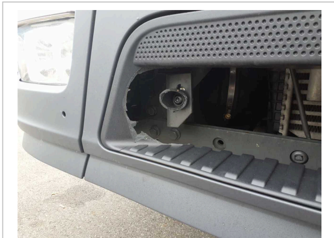
Beschädigung 10: Stossfänger vorn: Stossfänger vorn (Verstärkung) - gebrochen / gerissen - erneuern
