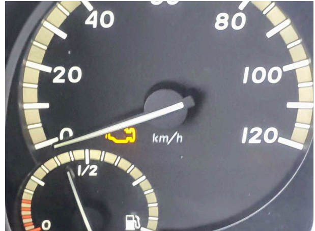
Beschädigung 7: Instrumententafel: Kontrollleuchte (Motor (Folgekosten möglich)) - Diagnose durchführen
