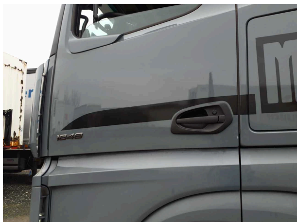
Beschädigung 2: Tür vorn links: Tür - Delle / Lackschaden - auslegen / polieren
