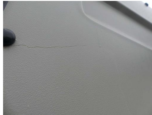
Türverkleidung links gebrochen
