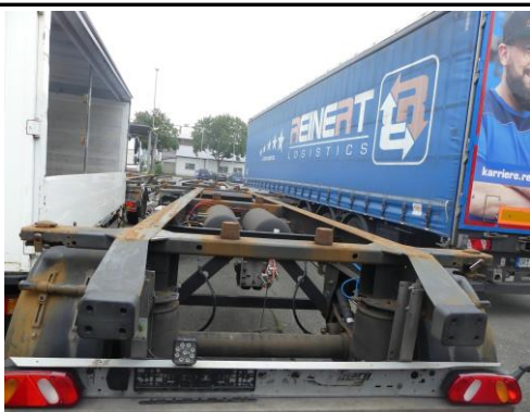
Ansicht Aufnahme Wechselbrücken
