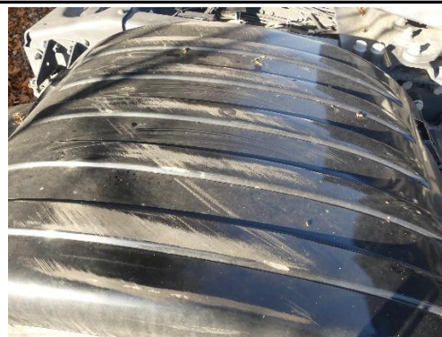
Kotflügelabdeckung rechts verkratzt
