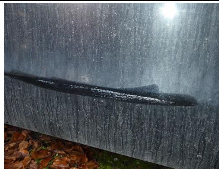
Rahmenverkleidung rechts verkratzt
