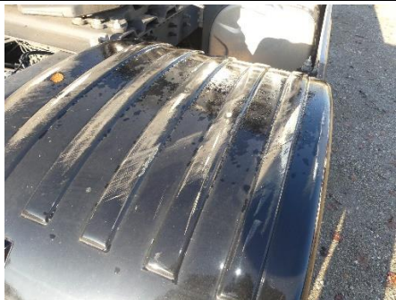
Kotflügelabdeckung rechts verkratzt
