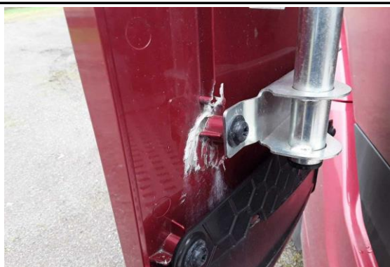
Luftleitkörper links gebrochen
