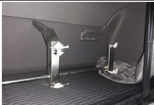
Halter Luftleitkörper rechts verformt
