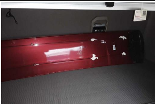
Luftleitkörper rechts gebrochen
