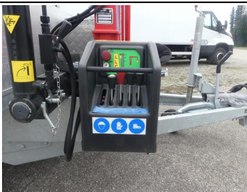
Ansicht Steuerung Ladekran
