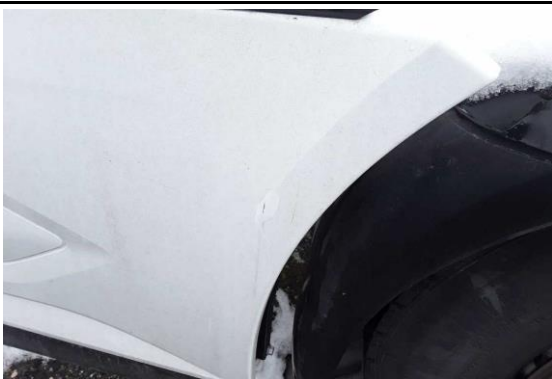
Rahmenverklidung links Kratzer
