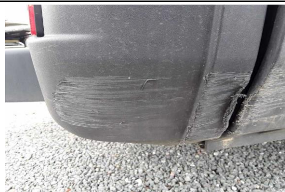
Stoßbecke / Bepplankung hinten rechts gebrochen
