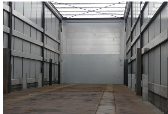
Laderaum mit Einsteckungen / Ladungsicherung
