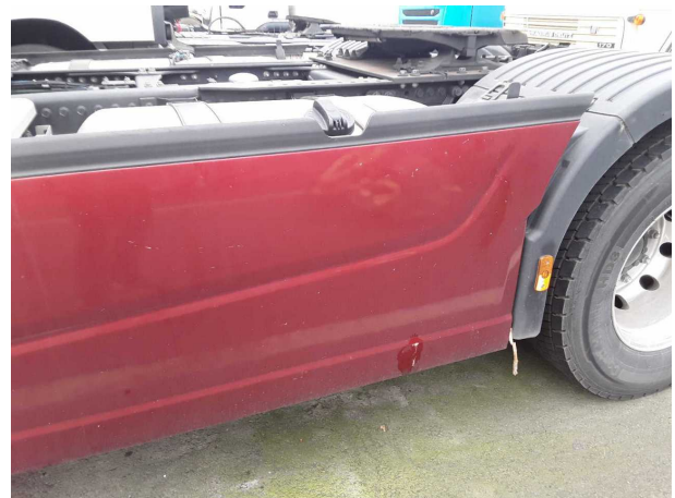
Beschädigung 4: Anbauteil links: Seitenverkleidung (Verkleidung links) - verkratzt / verschürft - lackieren
