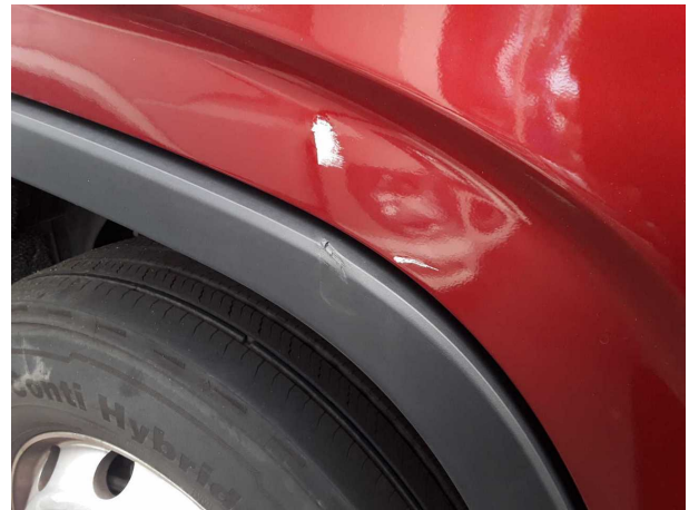
Beschädigung 3: Tür vorn rechts: Türverlängerung - verkratzt / verschürft - instandsetzen und lackieren
