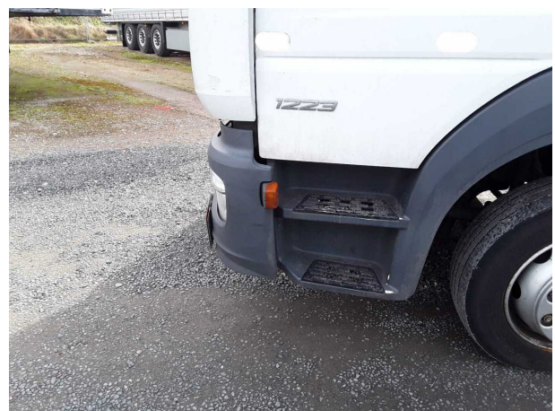
Beschädigung 2: Blinkleuchte: Blinkleuchte seitlich (Links) - beschädigt - erneuern
