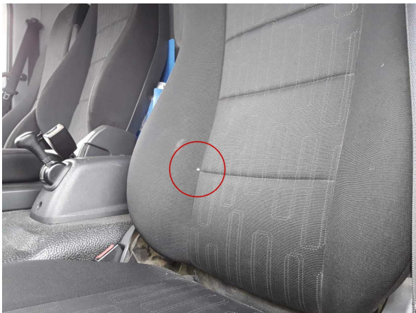
Beschädigung 7: Sitz vorn: Lehnenbezug links - Brandloch - Smart Repair
