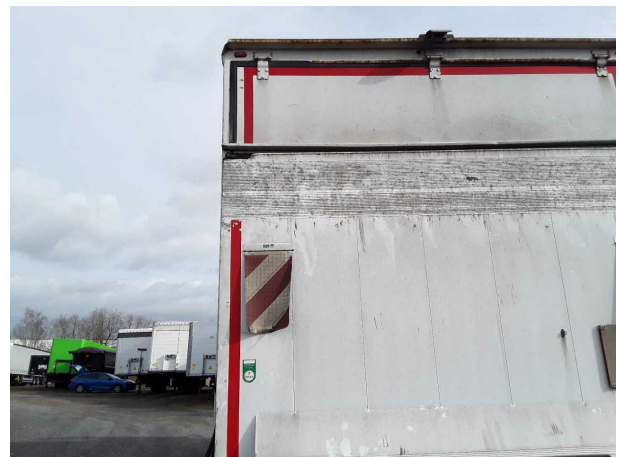
Beschädigung 14: Ladebordwand: Blatt - gebrochen / gerissen - instandsetzen
