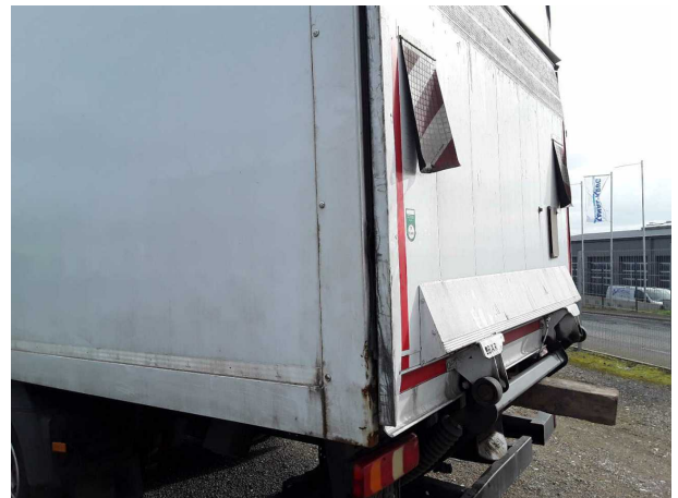
Beschädigung 9: Koffer: Portaldichtung - beschädigt - erneuern
