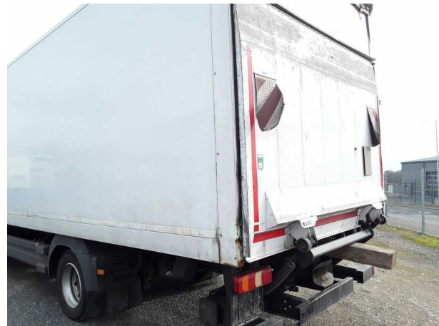
Beschädigung 16: Koffer: Eckprofil hinten links - Delle / Lackschaden - instandsetzen und lackieren
