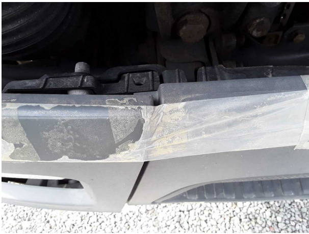
Beschädigung 6: Stossfänger vorn: Stossfänger vorn rechts - beschädigt - erneuern
