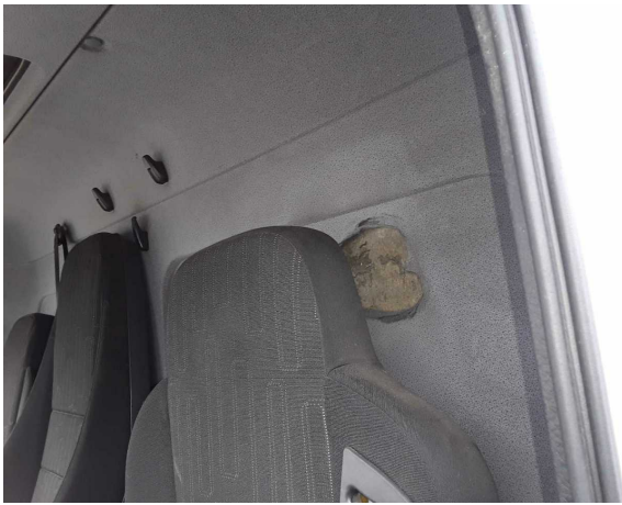
Beschädigung 20: Fahrerhaus: Rückwandverkleidung - beschädigt - erneuern
