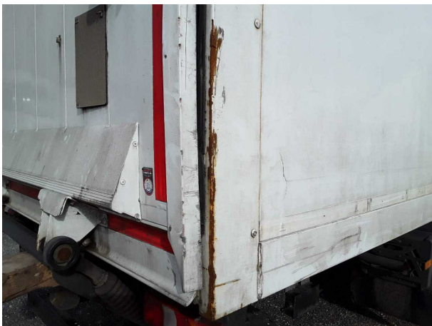
Beschädigung 13: Koffer: Eckprofil hinten rechts - verkratzt / verschürft - instandsetzen und lackieren
