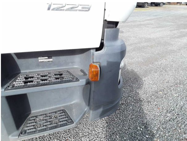
Beschädigung 3: Blinkleuchte: Blinkleuchte seitlich (Rechts) - beschädigt - erneuern
