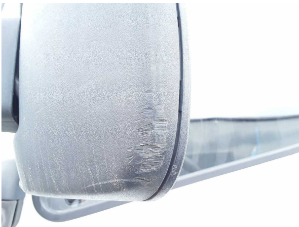
Beschädigung 10: Außenspiegel links: Rahmen (Unten) - verkratzt / verschürft - erneuern
