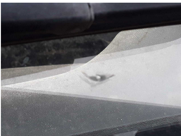
Beschädigung 22: Verglasung: Frontscheibe - Steinschlag - erneuern
