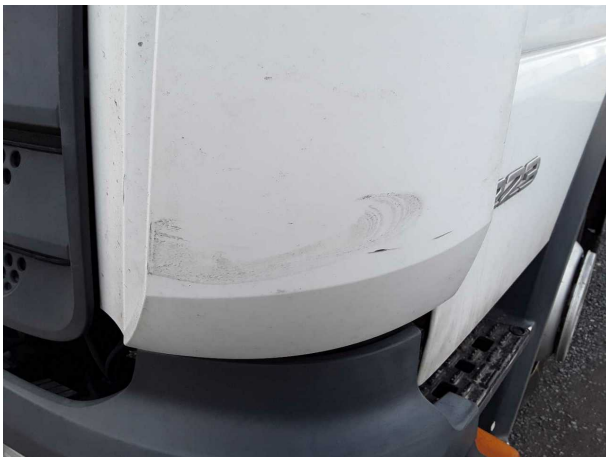
Beschädigung 15: Fahrerhaus: Luftleitkörper vorn links - verkratzt / verschürft - instandsetzen und lackieren
