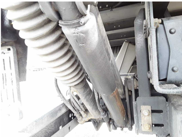
Beschädigung 12: Ladebordwand: Hydraulikzylinder (li. Manschette gerissen, Zylinder undicht. Folgek. möglich!) - ohne
