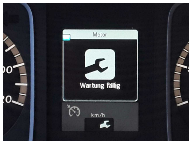
Beschädigung 23: Sonstiges: Inspektion/Wartung - fällig - durchführen
