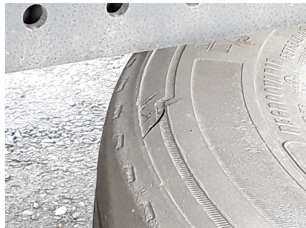
Beschädigung 17: Ausrüstung: Reserverad (eingerissen) - erneuern
