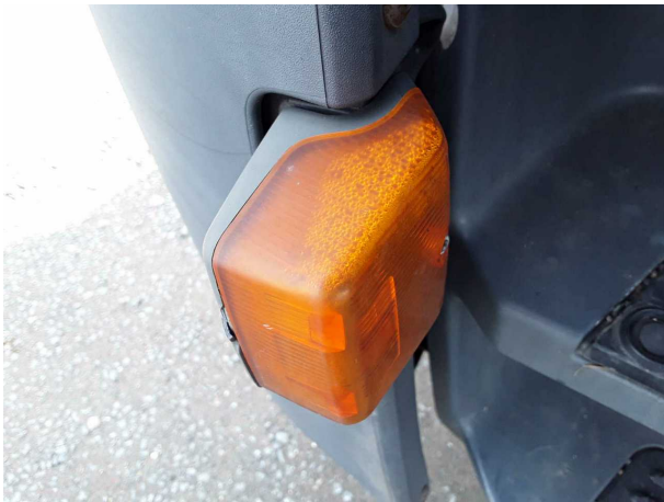
Beschädigung 2: Blinkleuchte: Blinkleuchte seitlich (Links) - beschädigt - erneuern
