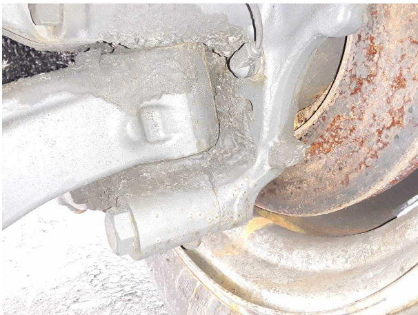
Beschädigung 21: Bremsanlage: Bremsscheiben vorn - verschlissen - erneuern
