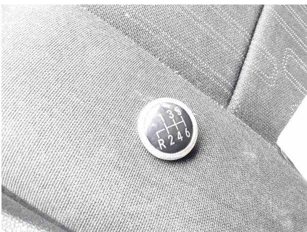
Beschädigung 1: Getriebe: Schaltknauf (Symbol) - beschädigt - erneuern
