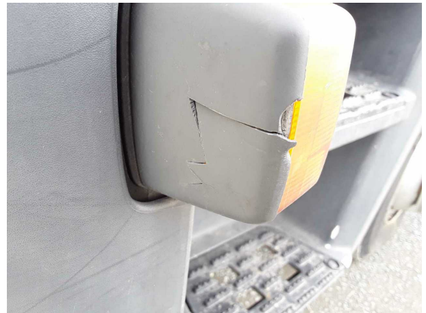
Beschädigung 2: Blinkleuchte: Blinkleuchte seitlich (Links) - beschädigt - erneuern
