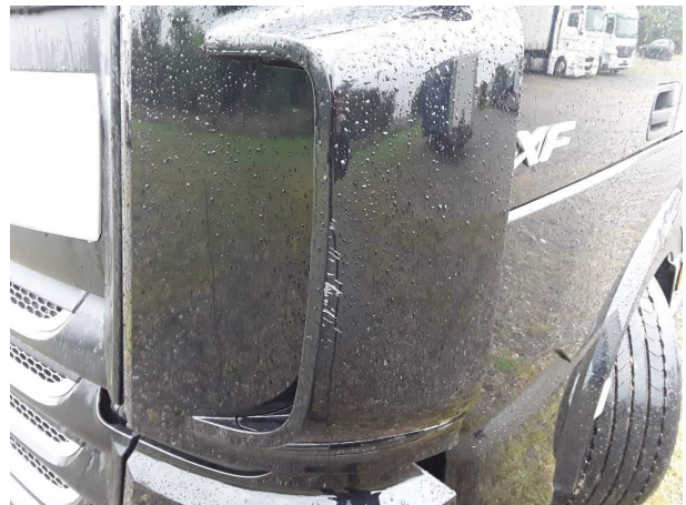
Beschädigung 6: Fahrerhaus: Luftleitkörper vorn links - verkratzt / verschürft - instandsetzen und lackieren
