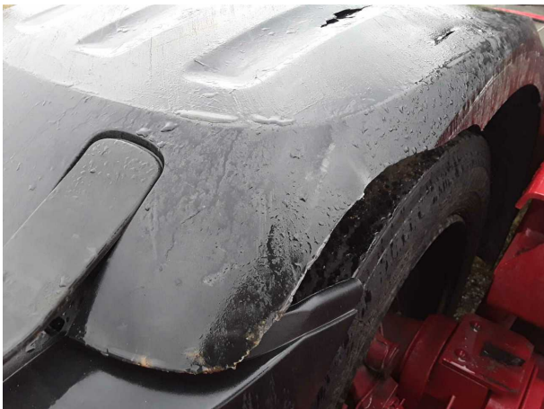
Beschädigung 5: Rahmen: Kotflügelabdeckung hinten links - gebrochen / gerissen - erneuern
