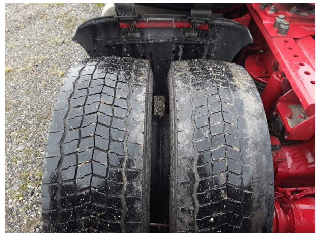
Beschädigung 7: Rad/Reifen: Reifen hinten (ungleich abgefahren) - verschlissen - erneuern
