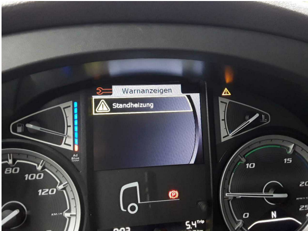
Beschädigung 3: Heizungssystem: Standheizung (Fogekosten möglich!) - Funktion / Zulässigkeit - befunden ggf. instandsetzen
