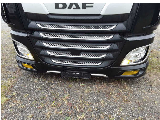
Beschädigung 1: Nebelleuchte: Nebelleuchte vorn links (und rechts) - unzulässig - instandsetzen
