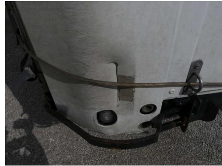
Eckrunge vorne rechts gebrochen/gerissen
