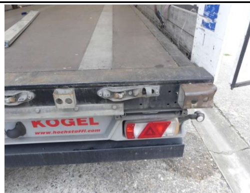
Rampenpuffer rechts verformt
