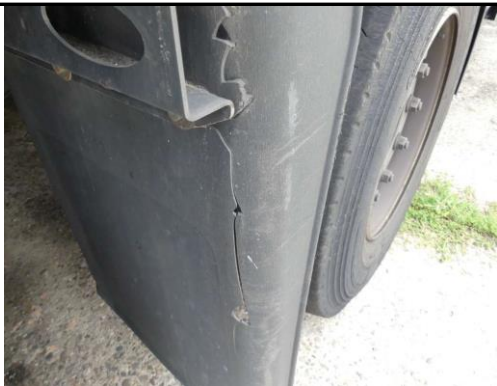
Kotflügel 1. Achse rechts gebrochen/gerissen
