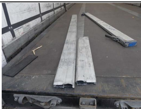
2 Alu Einstecklatten gebrochen/gerissen
