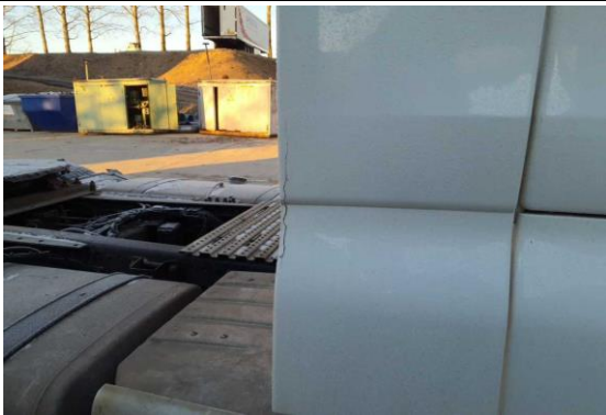
Luftleitkörper rechts gebrochen
