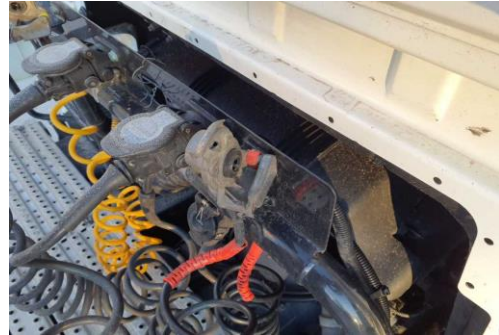
Staubschutzkappen Bremsanschlüsse gebrochen
