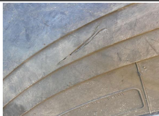
Reifen 3. Achse links schnittbeschädigt
