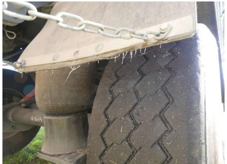
Schmutzfänger 3. Achse rechts gebrissen
