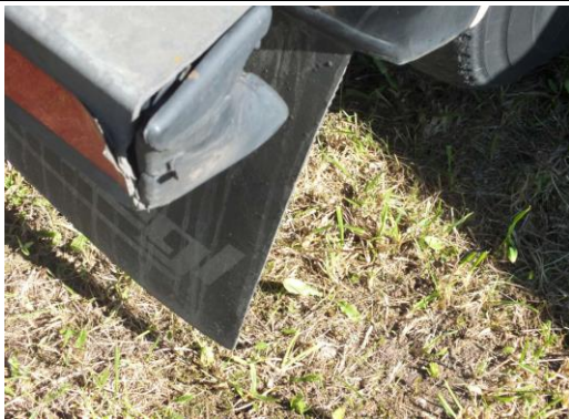
Unterfahrschutz Heck verformt
