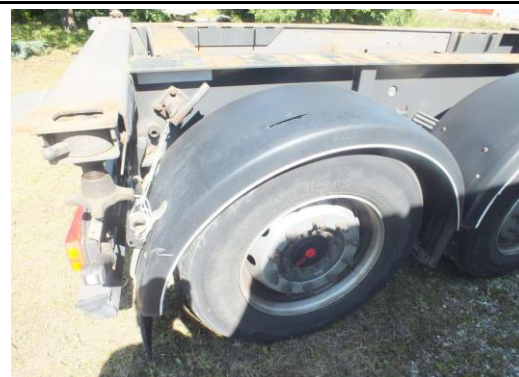
Kotflügel 3. Achse rechts gebrochen
