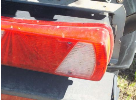
Glas Rückleuchte rechts gebrochen
