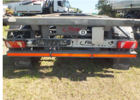
Unterfahrschutz Heck verformt
