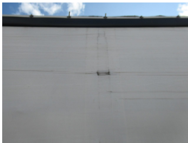
Beschädigung 8: Karosserie: Karosserie (Plane - links - gerissen) - gebrochen / gerissen - instandsetzen
