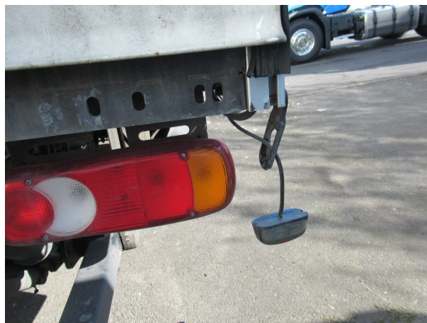
Beschädigung 1: Zusatzleuchte: Positionsleuchte rechts - gebrochen / gerissen - erneuern
