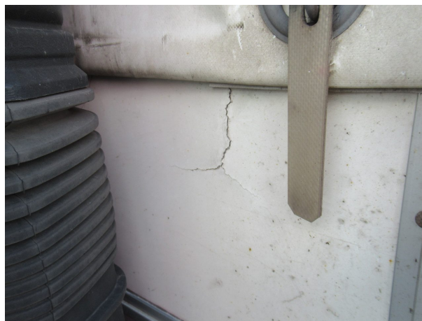
Beschädigung 12: Pritsche/Plane: Stirnwand (durchstoßen) - gebrochen / gerissen - instandsetzen und lackieren
