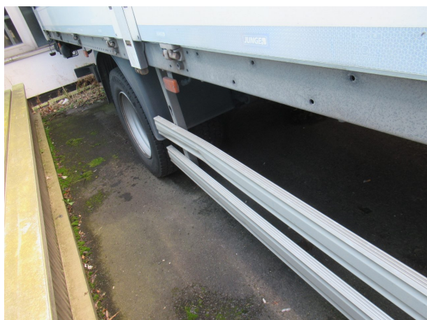
Beschädigung 2: Anbauteil rechts: Unterfahrschutzprofil - verformt - instandsetzen
