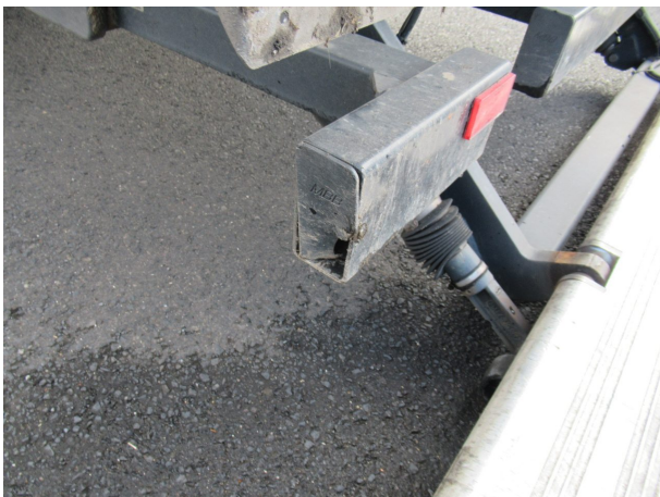
Beschädigung 1: Stossfänger hinten: Stossfänger hinten links (Abdeckkappe) - gebrochen / gerissen - erneuern
