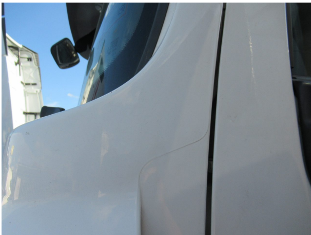
Beschädigung 8: Tür vorn links: Tür - nicht fachgerecht instandgesetzt - instandsetzen und lackieren
