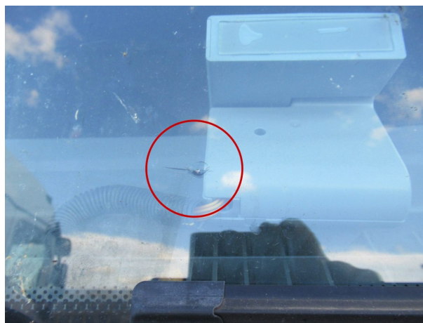
Beschädigung 11: Verglasung: Frontscheibe (Steinschlag 2x nicht reparabel) - gebrochen / gerissen - erneuern
