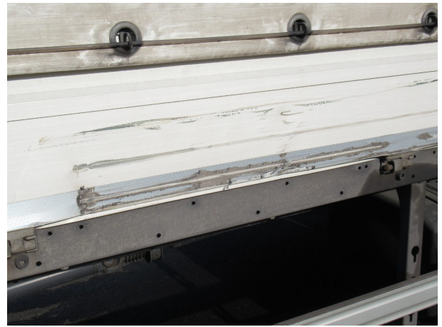
Beschädigung 7: Pritsche/Plane: Runge (rechts vorn) - verkratzt / verschürft - instandsetzen und lackieren
