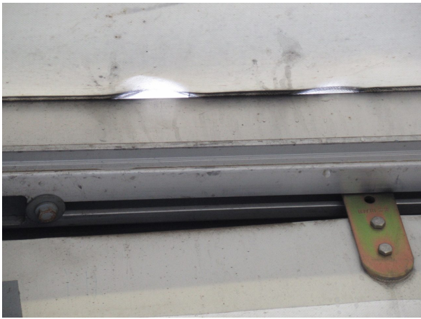
Beschädigung 5: Pritsche/Plane: Plane (Dach) - gebrochen / gerissen - instandsetzen
