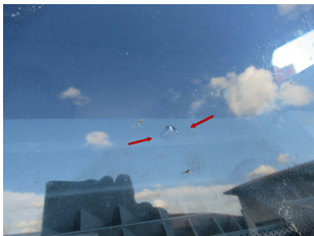
Beschädigung 11: Verglasung: Frontscheibe (Steinschlag 2x nicht reparabel) - gebrochen / gerissen - erneuern
