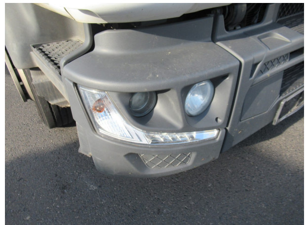
Beschädigung 9: Anbauteil rechts: Einstieg unten - gebrochen / gerissen - erneuern
