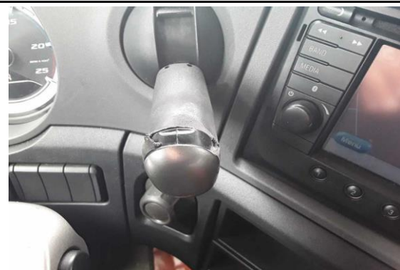
Hebel Feststellbremse stark abgenutzt
