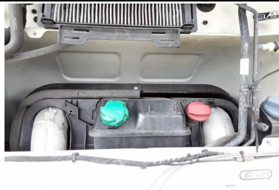
Abdichtung Kühler unvollständig
