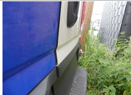
Fehlstellung Hecktür rechts
