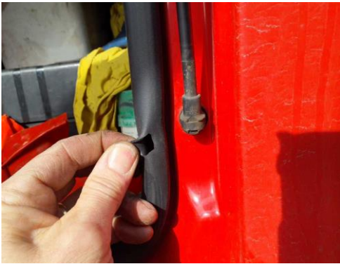
Staufachdeckel links Dichtung gerissen
