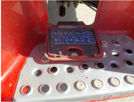
Deckel Einstieg rechts unten gebrochen
