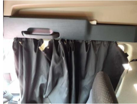
Vorhang rechts Befestigung gebrochen
