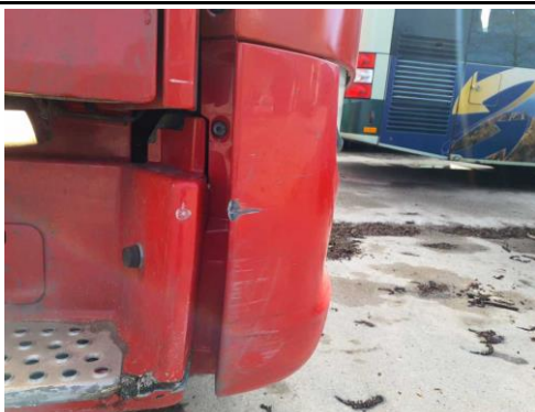
Einstieg oben/Stoßfängerecke rechts verkratzt
