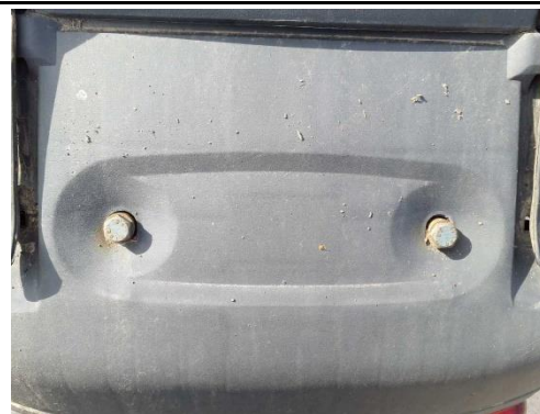
Kotflügel hinten rechts Befestigung lose
