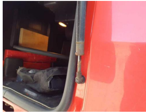
Staufachdeckel rechts Gasdruckdämpfer schwach
