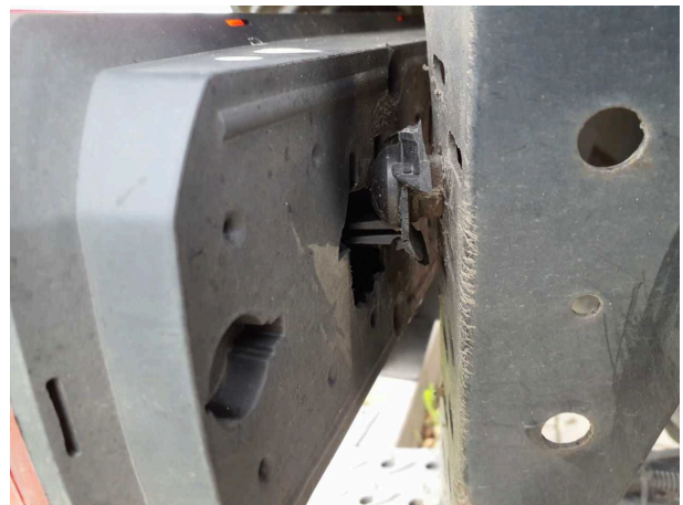
Beschädigung 9: Heckleuchte: Heckleuchte rechts - gebrochen / gerissen - erneuern
