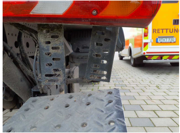
Beschädigung 8: Heckleuchte: Heckleuchte rechts (Träger) - verformt - erneuern
