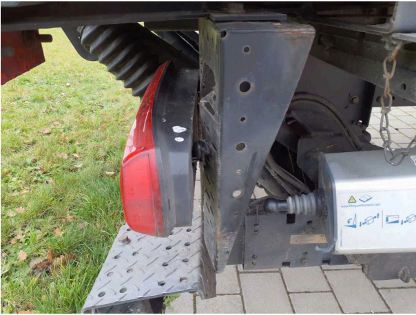
Beschädigung 8: Heckleuchte: Heckleuchte rechts (Träger) - verformt - erneuern
