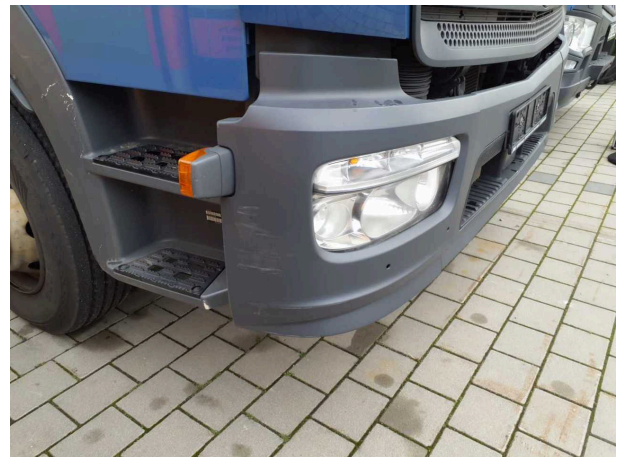
Beschädigung 6: Stossfänger vorn: Stossfänger vorn (Rechts) - verkratzt / verschürft - erneuern
