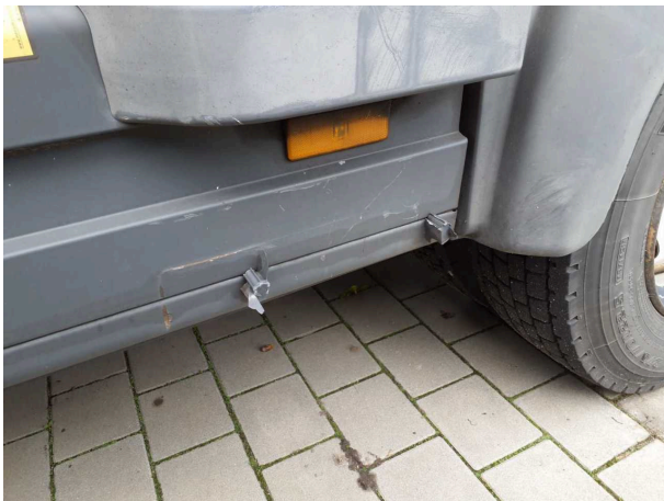
Beschädigung 5: Anbauteil links: Unterfahrerschutzprofil (Puffer) - fehlt - erneuern
