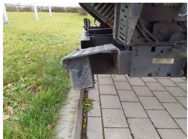
Beschädigung 7: Rahmen: Unterfahrerschutz hinten - verformt - erneuern
