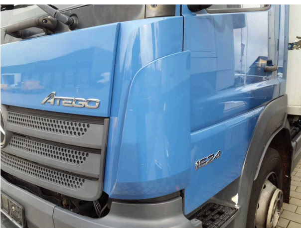
Beschädigung 10: Fahrerhaus: Luftleitkörper vorn links - verkratzt / verschürft - lackieren
