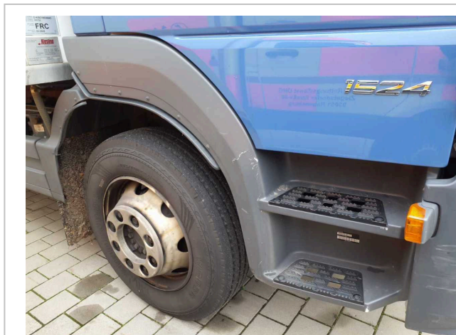
Beschädigung 12: Anbauteil rechts: Einstieg unten - gebrochen / gerissen - erneuern
