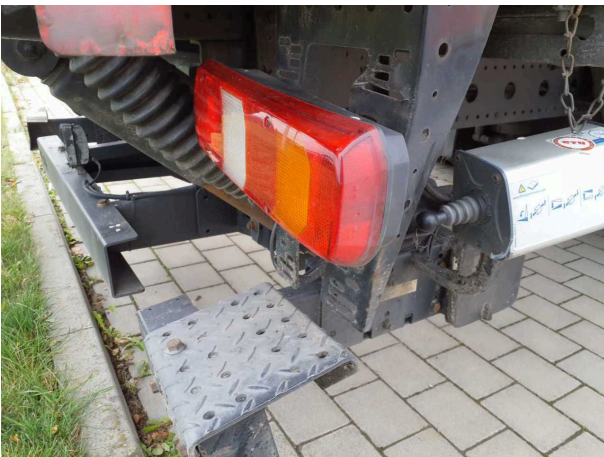
Beschädigung 9: Heckleuchte: Heckleuchte rechts - gebrochen / gerissen - erneuern
