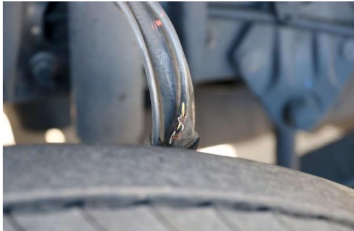
Sensorkabel Vorderachse L gerissen, gescheuert
