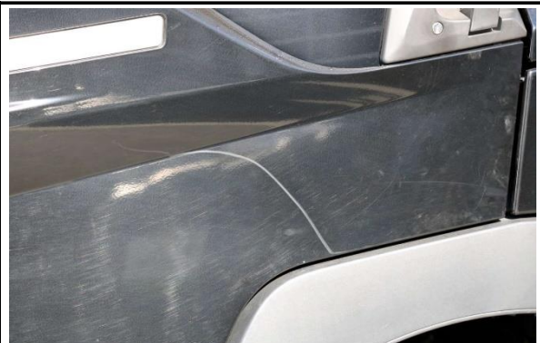
Türverlängerung links verkratzt, verschürft
