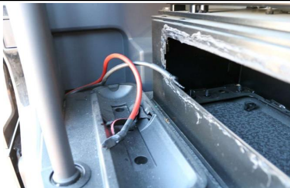
Kabel rechts Sitzkonsole demontieren
