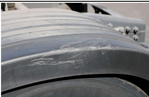
Radabdeckung HL verformt, verschürft
